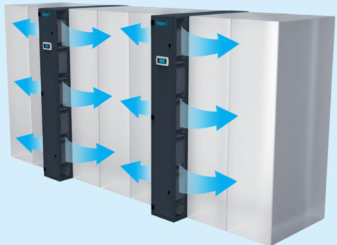
Прецизионные кондиционеры ByteCOOL Inrow – устанавливаются непосредственно между монтажными стойками в серверных комнатах. Благодаря горизонтальному забору и подаче воздуха, охлажденный воздух поступает напрямую в серверные стойки, формируя перед ними холодную воздушную завесу. Такие решения позволяют охлаждать серверные стойки высокой плотности. Также, межрядные кондиционеры совместимы с различными изолированными коридорами.
